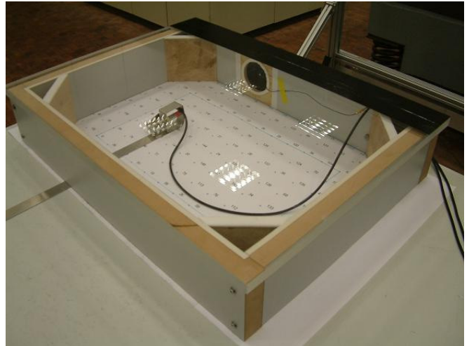
Abbildung 1: Versuchsaufbau mit abgeschragten Ecken, Netzknoten und verschiebbarem Messmikrofon.
