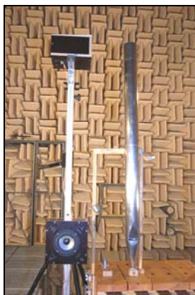
Abbildung 0: Aufbau von Lautsprechern und Stativ (links) zur Simulation der Pfeife (rechts)
