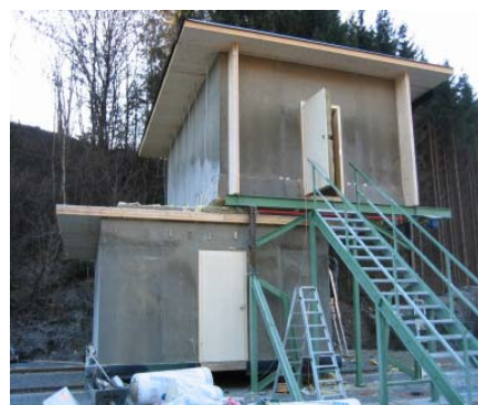
Abbildung 2: Hochflexibler Massivholz-Prüfstand, auf Schienen gelagert.
