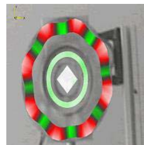
Abbildung 2a: Flächennormale Oberflächenschnelle einer Bremsscheibe für Shakeranregung 3234 kHz
