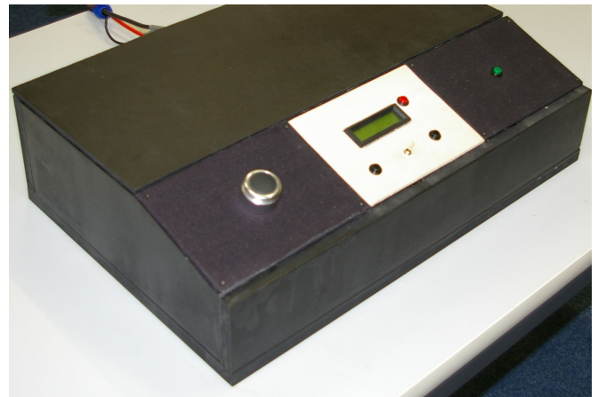
Abbildung 2: Akustiksimulator. Der große Drehknopf an der linken Seite wird benutzt, um die Wiedergabe der Geräusche auszulösen. Die Steuerung des Versuchsablaufs befindet sich im hellen Panel in der Mitte des Geräts.
