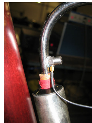
Abbildung 3: Beschleunigungssensor am S-Bogen.
