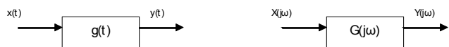
Abbildung 2: allgemeine Darstellung der Systemantwort g(t) und Übertragungsfunktion G(j\omega) mit Eingangs- ( x(t) , X(j\omega) ) und Ausgangsfunktion ( y(t) , Y(j\omega) )
