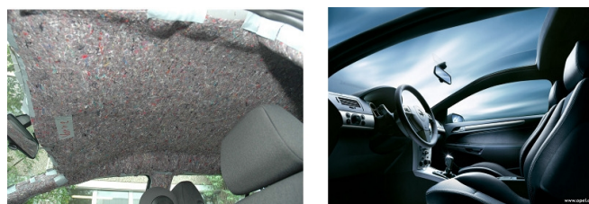
Abbildung 1: Opel Zafira mit zusätzlicher absorptiver Auskleidung (links) und Opel Astra GTC mit Panorama-Windschutzscheibe (rechts) zur Untersuchung extremer Fahrzeugzustände
