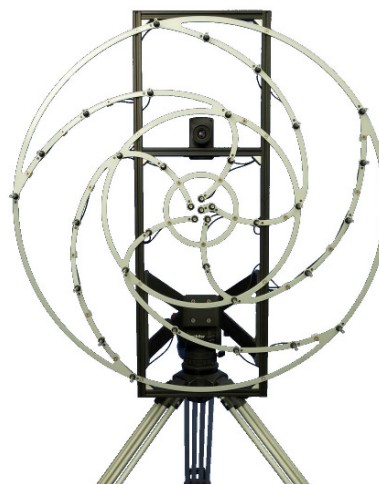
Abbildung 1: Mikrofonarray aus 36 1/4' ICP Mikrofonen, angeordnet auf 5 Spiralbahnen.
