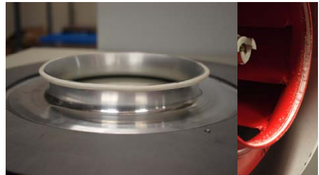
Abbildung 2: links: Einlaufdüse mit Dichtband, rechts: Laufrad mit Schleifspuren des Dichtbandes nach den Messungen.
