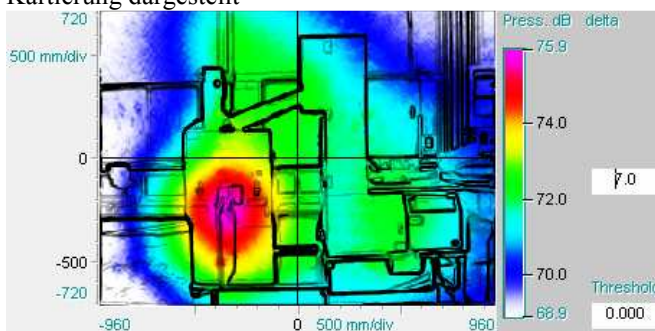
Abbildung 7: Akustisches Foto einer Geldzählmaschine mit Standardbeamforming. Hauptquelle ist die Prallplatte
