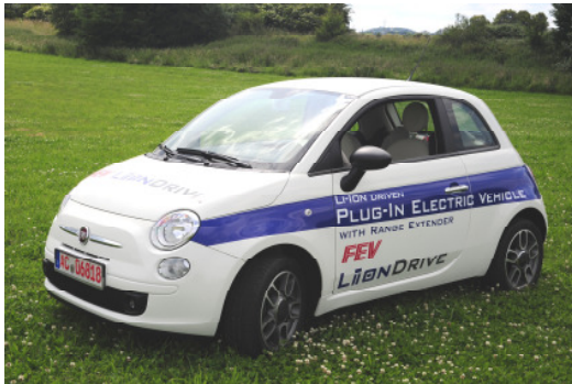
Abbildung 1: FEV-LIIONDRIVE Elektrofahrzeug mit 30kW 100Nm (60kW 180Nm peak) Permanentensynchronmotor, 12kWh Li-Ion Batterie, 20kW Range Extender Wankelaggregat, 80km elektrische Reichweite, 0-60km/h in 6 sek, v_{max} 120km/h.
