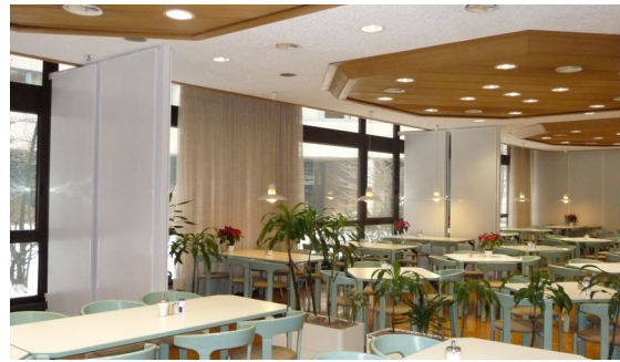
Abbildung 1: Breitband-Kompaktabsorber an Wänden und in Stellwänden beruhigen inzwischen die BGN-Kantine als „Startschuss“ für ein ambitioniertes F&E-Projekt
