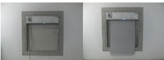
Abbildung 1: Rollladenkasten mit auf- und abgezogenem Rollpanzer bei der Messung der Norm-Schallpegeldifferenz D_{n,e} im Fensterprüfstand an der HFT Stuttgart.
