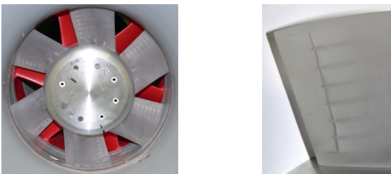
Abb. 3: Links: Untersuchter Niederdruckaxialventilator mit Nachleitrad(rot), rechts: Sieben Ausblasseitze
