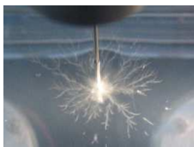
Abb. 6: Edelstahllwellenleiter im Zentrum einer nahezu unverändert weiter kavitierenden Blasenstruktur.
