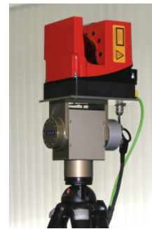
Abbildung 3: Laserscanner bestehend aus Standardkomponenten zur Erstellung von 3D-Modellen
