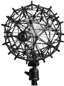
Abbildung 1: 3D-Array mit 48 räumlich verteilten Mikrofonen (Sphere48) zur Messung in Innenräumen
