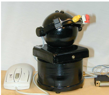
Abbildung 1: Verwendetes optisches System zur Bestimmung der Richtung der Schallquelle.
