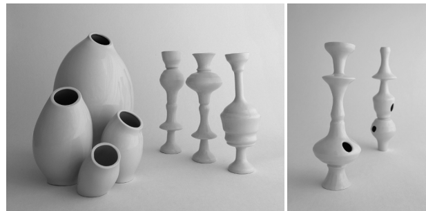
Abbildung 1-2: Abb. 1 (v.l.): Vier gestimmte Hohlraumresonatoren und drei Vokaltraktmodelle mit Mundstück (L = 21 cm). Abb. 2 Eine Auswahl an Funktionsmodellen: Zusätzliche Schallaustrittsflächen an einer abrupten Querschnittserweiterung erzeugen eine deutlich hörbare Resonanz (hier: ca. 700 - 900 Hz). Darüber können insbesondere die Obertöne des Stimmpektrums gezielt betont werden.
