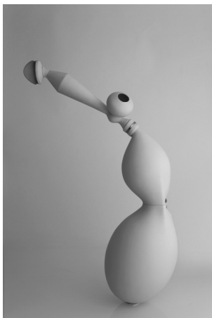
Abbildung 3: Aufbau (v.l.o.): Mundstück, austauschbares Stimmfilterelement mit integriertem Hohlraumresonator V_{4\frac{1}{2}} , große Hohlraumresonatoren V_2 und V_1 . Der größte Resonator V_1 ist nicht direkt mit System verbunden. Er wird wahlweise über die Schallreflektion an der Handfläche zum Resonieren angeregt und agiert als Helmholtz-Resonator.
