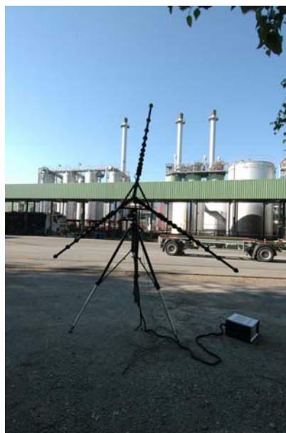
Abbildung 1: Stern-Array der Akustischen Kamera vor einer offenen Industrieanlage mit mehreren Behältern und Abgasfängen
