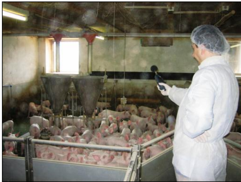
Abbildung 2: Messung des Innenpegels in einem Ferkelstall, Bildquelle: LFZ Raumberg-Gumpenstein
