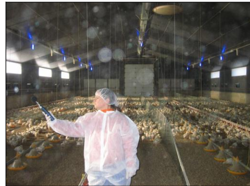
Abbildung 1: Messung des Innenpegels in einem Mastgeflügelstall, Bildquelle: LFZ Raumberg-Gumpenstein
