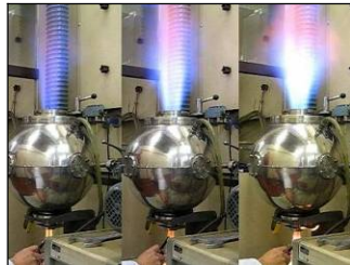
Abbildung 4: Stichflamme nach den Einsprühzeiten 1, 2 und 3 Sekunden (von links nach rechts)
