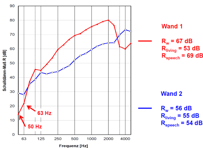
Abbildung 2: Vergleich R w und R living zweier Wände Wand 1: Trockenbauwand mit CW100-Profilen und 2 x 12,5 mm Gipsplatten auf jeder Seite. Plattengewicht: 17,5 kg/m 2 Wand 2: Kalksandsteinwand 175 mm, 328 kg/m 2
