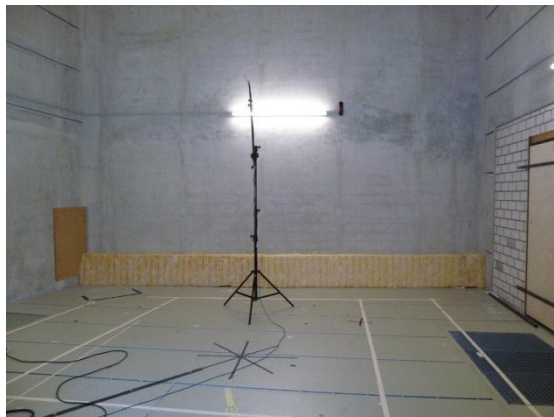
Abbildung 2: Messaufbau im Hallraum; hier Kanten-Absorber ohne Abdeckung, siehe Abb. 1B
