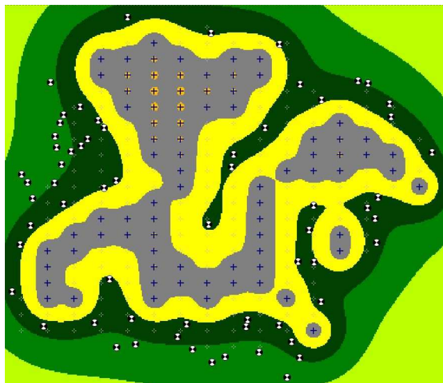
Abbildung 2: Schallpegel im Umfeld von 83 WEA mit L_{WA} = 103 dB je Anlage
