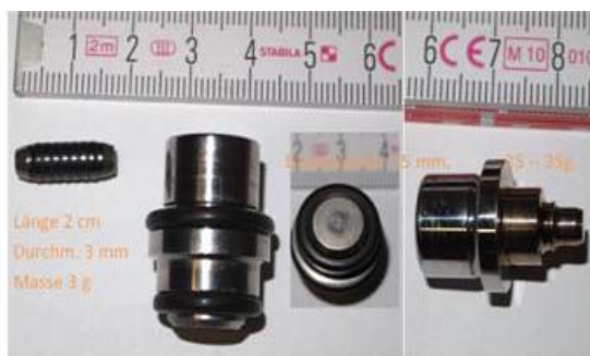
Abbildung 1: Projektil (3g Masse) und zwei Applikatoren mit je 15mm Durchmesser (25 – 35g Masse, verschiedene Hersteller).
