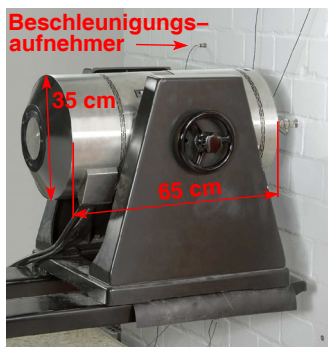
Abbildung 1: Schwingungserreger (Brüel & Kjær Typ 4802 mit Brüel & Kjær Typ 4818) vor Kalksandsteinwand, im Hintergrund ein Beschleunigungsaufnehmer; Quelle: [4]
