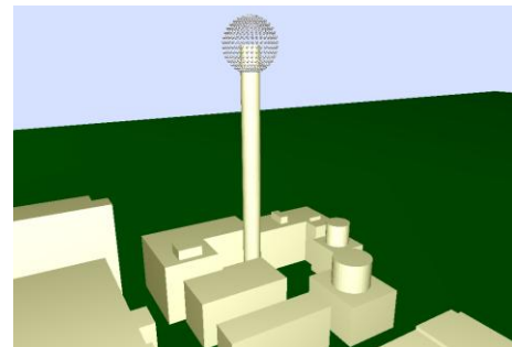
Abbildung 1: Computermodell eines Industrieprojekts mit kugelförmig um die Schornsteinöffnung angeordneten Immissionspunkten
