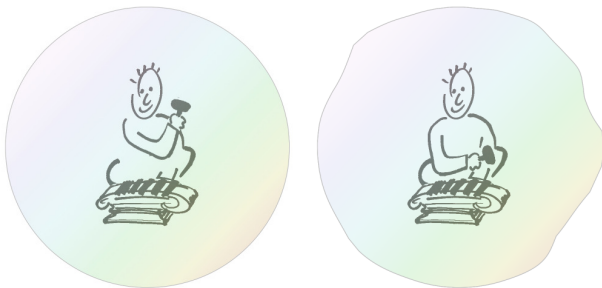
Abbildung 2: Seifenblasenmodell: eine Seifenblase (masselos, reibungsfrei, steifigkeitsfrei) um Instrument und MusikerIn stellt bereits ein holografische Abbild der Schallabstrahlung ins Freifeld dar. Die Blase schwingt an allen Punkten der richtungsabhängig abgestrahlten Schallschnelle entsprechend.
