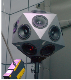
(b) Laservibrometermessung ermöglicht Messung des Übersprechens bei geringem Einfluss akustischer Reflexionen.
