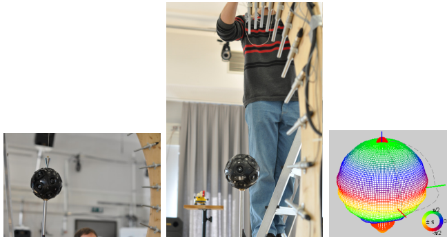
(a) genau zentrierte Messung der Lautsprecheranordnung auf einem Drehteller mit Mikrofonen erlaubt Überprüfung der Abstrahlung mit Ballondiagrammen.
