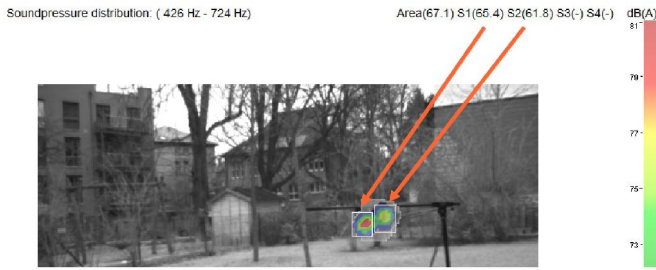
Abbildung 15: Abbildungsleistung des SIA Verfahrens an einem Beispiel mit 500Hz Schmalbandrauschen in 5m Abstand zur Kamera. Die Quellen sind 30cm voneinander entfernt.
