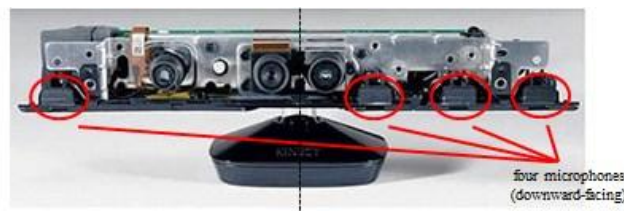
Abbildung 31: Microsofts Kinect enthält 4 Mikrofone, die mittels Beamforming zu einem Richtmikrofon werden.
