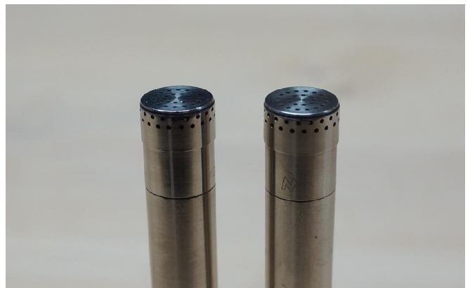
Abbildung 1: Das kleinste Array besteht aus zwei Mikrofonen.
