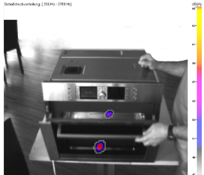
Abbildung 18: Gleichzeitige scharfe und klar fokussierte Abbildung mehrere Schallquellen aus unterschiedlichen Abständen an einem Backherd.
