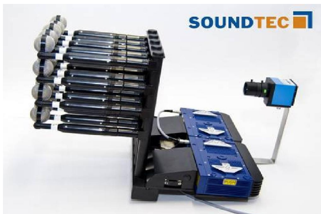
Abbildung 11: Akustische Nahfeldkamera bestehend aus 20 Schnellesonden. Damit wird direkt die Schallschnelle vor der Objektoberfläche gemessen. Eine Rückrechnung auf die Objektebene ist i.d.R. nicht nötig.
