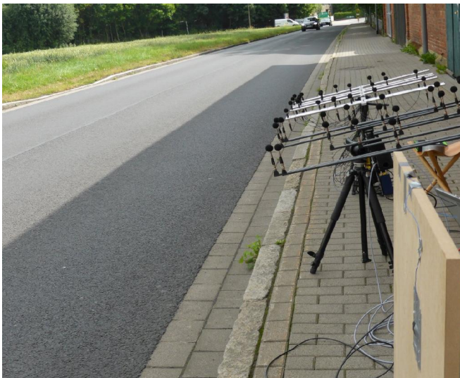
Abbildung 27: Messaufbau mit 2-dimensionalen Arrays und Backing Board zur Messung des Vorbeifahrt Pegels vor einer stark reflektierenden Hauswand.
