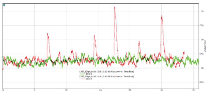
Abbildung 7: Vergleich der dB(A)-Pegel zweier Messungen auf gleicher Strecke mit und ohne Überfahren von Asphaltchäden
