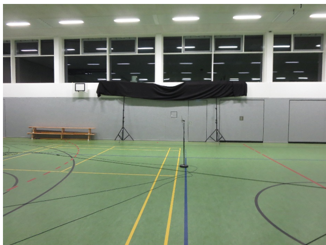
Abbildung 11: Halle 4 mit 5,8 m 2 Moltonstoff oberhalb des Prallschutzes an einer Längswand
