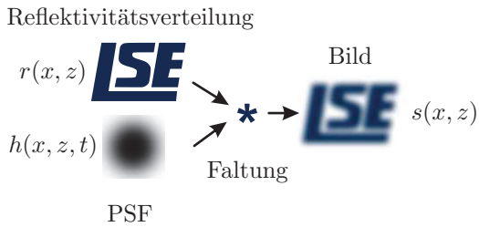
Abbildung 3: Räumliche Faltung der Reflektivitätsverteilung r(x, z) mit der Punkt-Bild-Funktion h(x, z, t) liefert das Bild s(x, z) .
