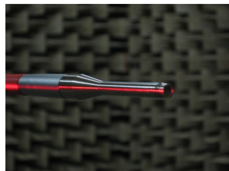
Abbildung 2: 1/4"-Mikrofonkapsel auf einem Adapter zu 1/2"-Gewinde mit 1/2"-Vorverstärker.
