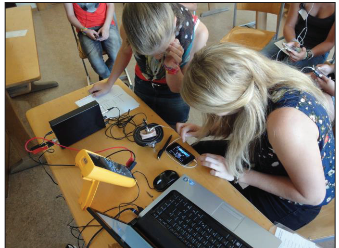
Abbildung 1: Versuchsaufbau "künstliches Ohr" zur Messung der Schallpegel der mitgebrachten Musikwiedergabegeräte.
