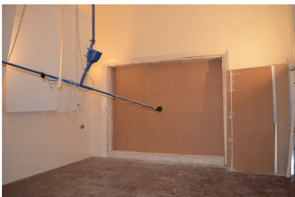
Figure 2: Reverberation room measurements (EN 1793-1)
