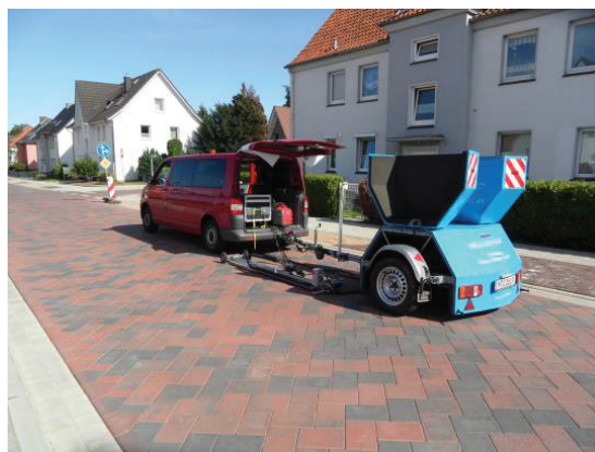
Abbildung 1: CPX-Messsystem auf einer der untersuchten Messstrecken.
