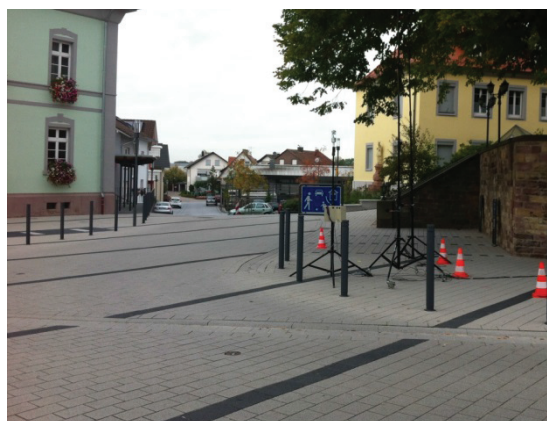
Abbildung 2: SPB-Messsystem an einer der untersuchten Messstrecken.
