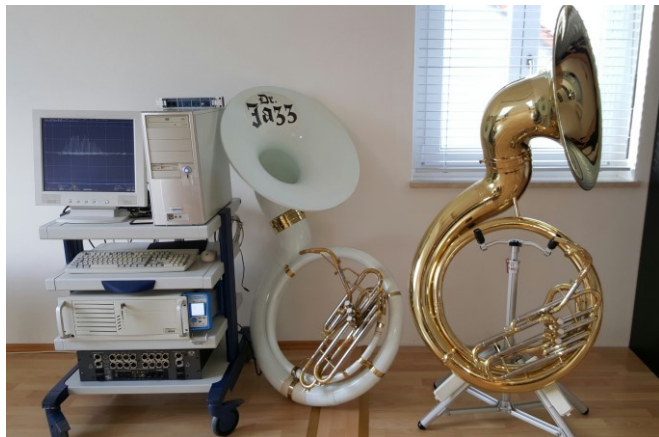
Abbildung 1: Messplatz mit Kistler 5018 Ladungsverstärker, Four-Audio Monkey Forest Software, ITADDA16 Robo Frontend, Spectra DOS Rechner und Yamaha YSH-301 und YSH-411 Sousaphon.
