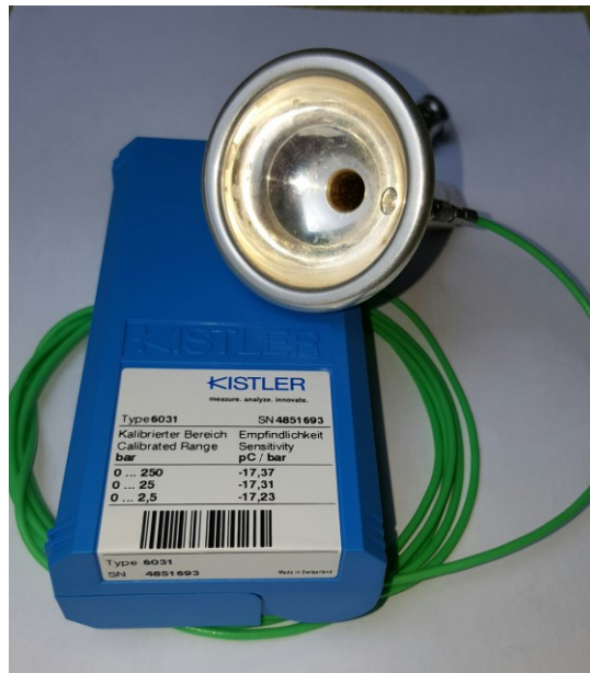
Abbildung 2: Mundstück mit eingebautem Kistler 6031 Drucksensor.
