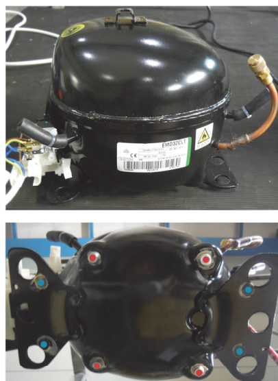
Abbildung 1: Kompressor und Interface-Positionen; ● vorgesehene Interface, ● zusätzliches Interface
