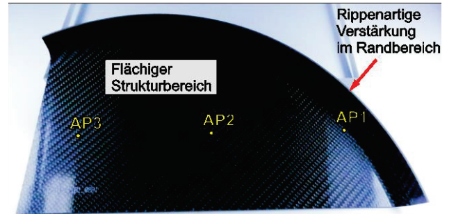
Abbildung 1: Untersuchte Faserverbundstruktur (Abmessung: ca. 449 × 255 × 40 mm); Bauteilorientierung: R.
