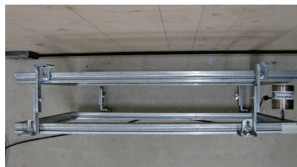
Abbildung 6 Referenzquelle mit vier Befestigungspunkten und Shaker als Erregerquelle.
