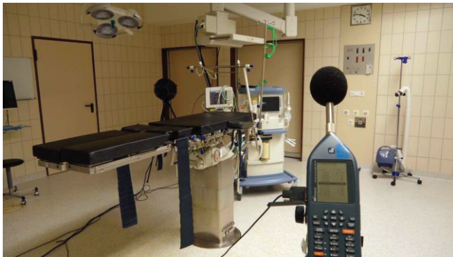
Abbildung 4: Messstation der Nachhallzeiten mit Norsonic-Dodekaeder (im Hintergrund) im OP 1. Der OP 2 ist baugleich.
