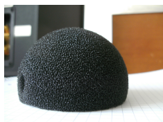
Abbildung 4: Primärer Windschirm, 7 cm Durchmesser
