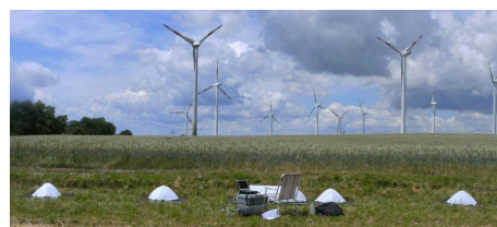
Abbildung 7: Mikrofonarray vor dem Windpark mit 10 WEA; die untersuchte Anlage ist die nächst gelegene auf der linken Seite
