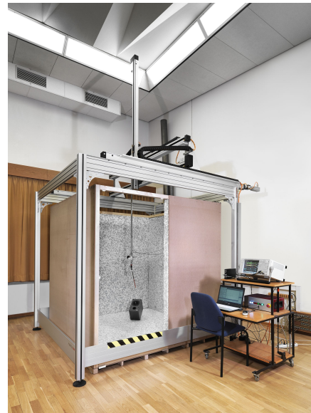
Abbildung 2: 3-Achsen-Portalscanner zur räumlich hochauflösenden Abtastung von Schallfeldern (vgl. [9], Abb. 2).
