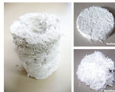
Abbildung 7: Links: Absorberkern aus PTFE-Fasern nach der Entnahme aus dem Schalldämpfer. Rechts: Gepresste Vergleichsprobe vor und nach einem Waschgang.
