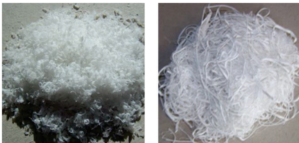
Abbildung 1: Fotos der erstellten Span-Schüttung (links) und des Faserverbunds (rechts).
