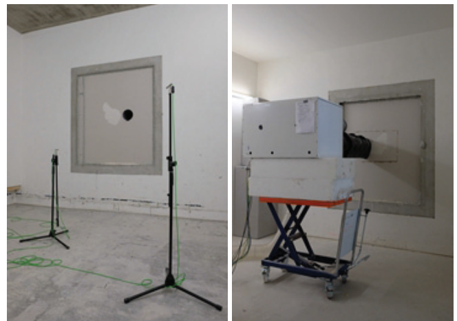
Abbildung 5: Bestimmung der Schallabstrahlung in die Kanäle im Fensterprüfstand der HFT Stuttgart. Links Messung im Empfangsraum, rechts Aufbau Lüftungsgerät mit Kanal im Senderaum.
