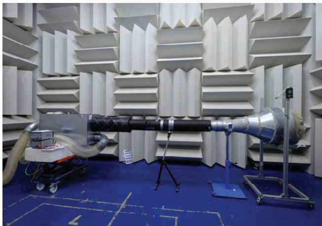
Abbildung 4: Messkanal mit Lüftungsgerät (links) und reflexionsarmem Abschluss (rechts) im Halbfreieldraum der HFT Stuttgart.
