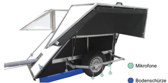
Abbildung 7: Ansicht der Neukonstruktion als Zweirad-Anhänger mit geöffneten Hauben. Gezeichnet sind die Mikrofonpositionen nach DIN EN ISO 11819-2 und die innere Bodenschürze.
