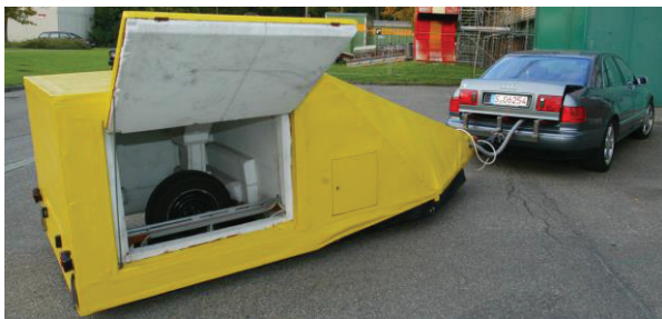
Abbildung 5: Einrad-Anhänger mit neuem Zugfahrzeug und geöffneter Zugangsklappe. Man erkennt den begrenzten Zugang zum Messrad und zur Messtechnik.
