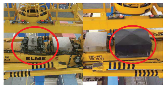
Abbildungen 7 und 8: Kran-Spreader ohne (links) und mit (rechts) Kapselung Hydraulik (Quelle: Duisburger Hafen AG)
