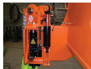
Abbildung 13: Spreader mit hydraulischen Stoßdämpfern (Quelle: VDL Containersystemen b.v.)
