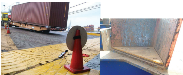
Abbildungen 14 und 15: Rolltrailer mit Container (links) und Polyurethan-Platte im Rolltrailer Eckrahmen (rechts (Quelle: UNIKAI Lagerei- und Speditionsgesellschaft mbH Hamburg)
