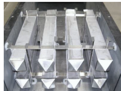
Abbildung 6: Eingebauter Säulenschalldämpfer in die Messstrecke.
