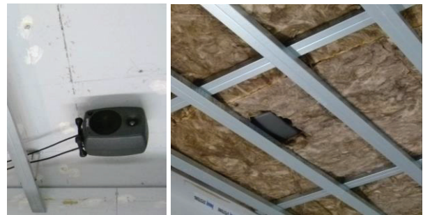
Abbildung 1 Lautsprecher in Prüfposition als Schallquelle zur Bestimmung der Einfügungsdämmung D_E . Links ohne und rechts mit Mineralwolle. [E-200].
